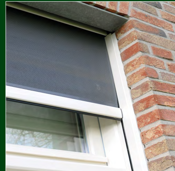
Duco Twin, inbouwscreen voorzien van ventilatierooster. Weggewerkt achter de gevel, eventueel elektrisch bediend met inbouwschakelaar.
